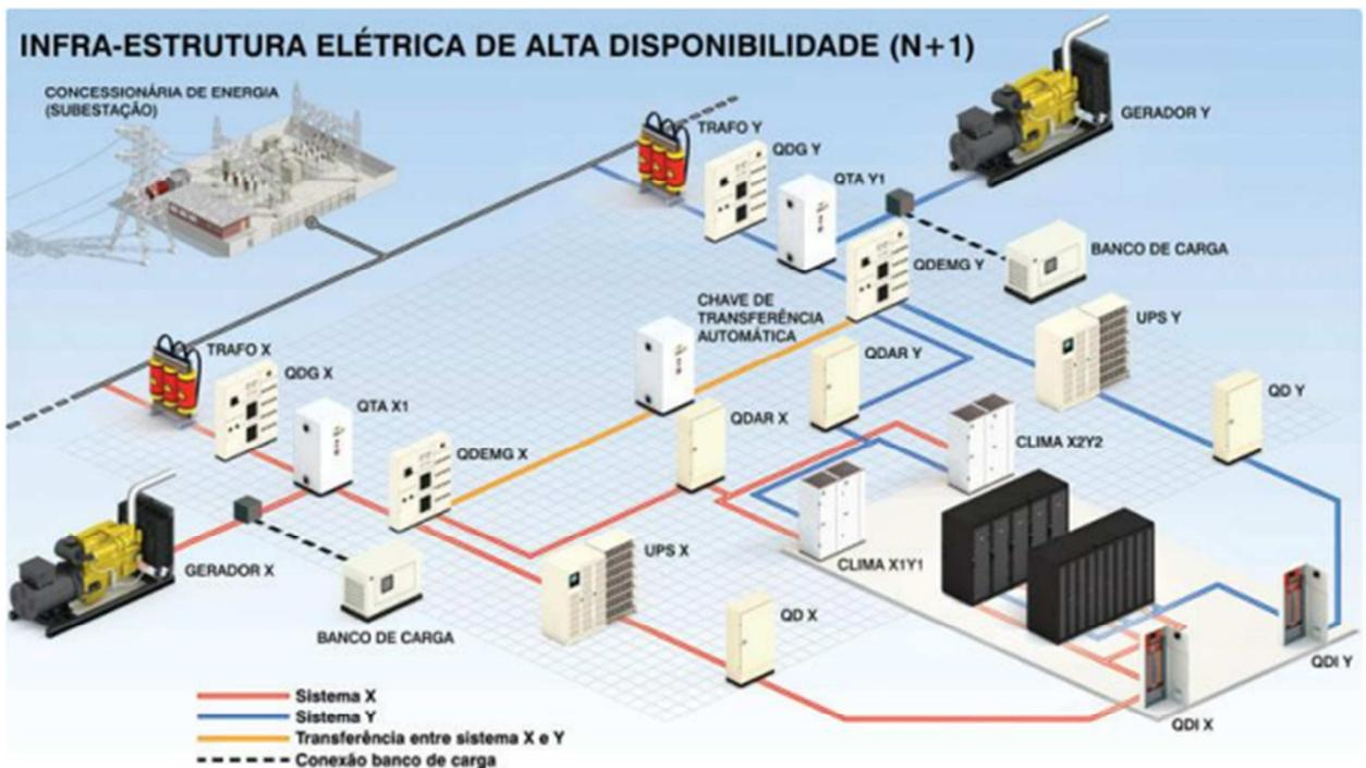
Figura 3: Esquema de Rede Elétrica Redundante N+1. Fonte: <http://www.acecoti.com.br>.
